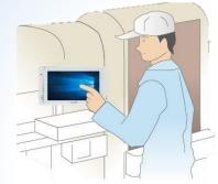
操作盤やボックスを 作らずに、VESA取 付で装置に取りつ けられコスト削減が できます。タッチパ ネルも抵抗膜方式 と静電容量方式を 使用される環境で 選ぶことができます。
