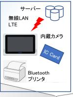
VESA取付で、フレキシブル に設置。ICカードで打刻漏れ や入力ミスを低減させた入退 出管理システムができ、内蔵 カメラでセキュリティーの強化 も可能。受付端末として Bluetoothプリンタと連動して、 受付番号札の打出しもできま す。
