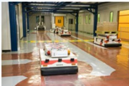
無人搬送機、搬送ロボット等で小型組み込みPC +イーサCATで制御システムを構築できます。無線やBluetooth、LTEを使うことで搬送機の稼働、警報履歴の外部からの確認や、動作指示が可能。
