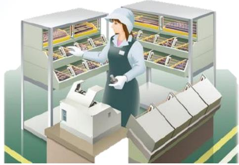
セル生産での組み立て時、ピッキングシステムのセンサ入力、ランプ点灯の配線を省配線化することによりレイアウト変更等の工数削減が可能になる
