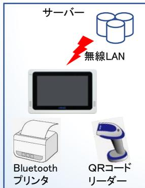
VESA取付で、現場で簡単に設置。無線LANでネットワークにも簡単に接続。Bluetoothを利用した周辺機器でフレキシブルなシステムが作れます。また、UPS内蔵で、不用意な電源遮断でも、データやOSを保護します。UPSシリーズは無線LANのみの対応。
