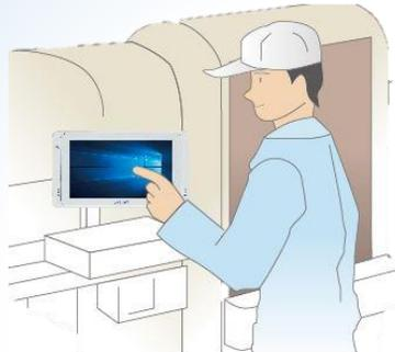
操作盤やボックスを作らずに、VESA取付で装置に取りつけられコスト削減ができます。タッチパネルも抵抗膜方式と静電容量方式を使用される環境で選ぶことができます。
