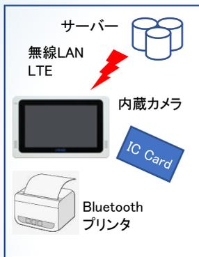
VESA取付で、フレキシブルに設置。ICカードで打刻漏れや入カミス低減させた入退出管理システムができ、内蔵カメラでセキュリティの強化も可能。受付端末としてBluetoothプリンタと連動して、受付番号札の打出しもできます。
