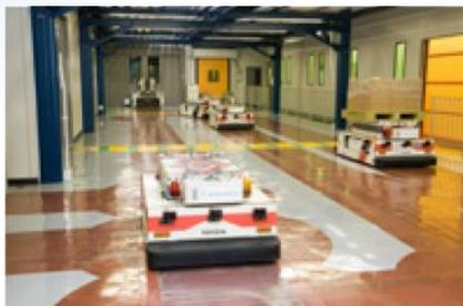
無人搬送機、搬送ロボット等で小型組み込みPC + EtherCATで制御システムを構築できます。無線やBluetooth、LTEを使うことで搬送機の稼働、警報履歴の外部からの確認や、動作指示が可能となります。
