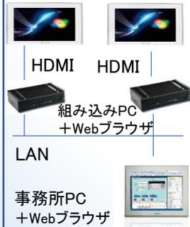
大型液晶表示パネルに組み込みPCを使用(現場の状況で液晶の大きさを自由に変更できる)、事務所のPCよりWebブラウザを使い、各組み込みPCに生産に必要なメッセージや情報を表示を行う等の用途にご使用できます。
