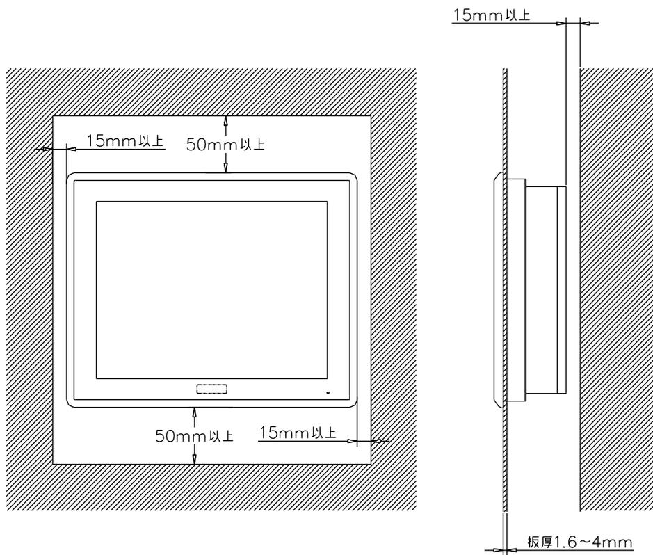
放熱の為、他の機器は本体より上下側は 50mm 以上、左右、背面側は 15mm 以上、離して設置してください。(上図参照)
