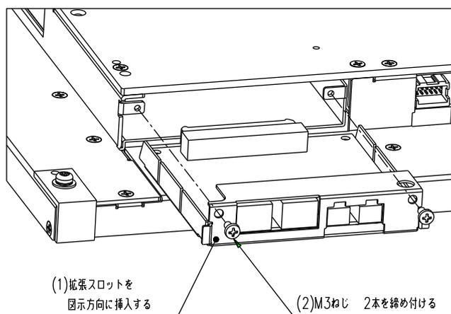
取付け金具の締め付けトルクは 0.35Nm です。強く締めすぎると製品を破損するおそれがありますので注意してください。
