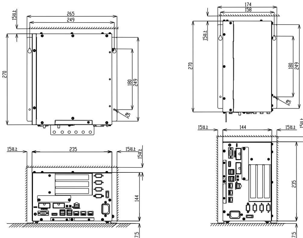
放熱の為、他の機器は本体より15mm以上離して設置してください。
