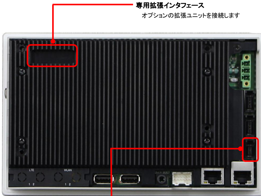
POWER スイッチコネクタ (P-SW CN) 接続については「第 4 章 接続」を参照してください 動作については「第 5 章 操作方法」を参照してください
