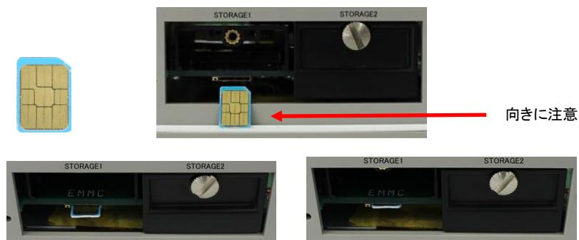
3. LTE 用 SIM カードを抜く際は、SIM スロットに挿さっている LTE 用 SIM カードを奥まで押し込むと LTE 用 SIM カードが SIM スロットから出てきます
