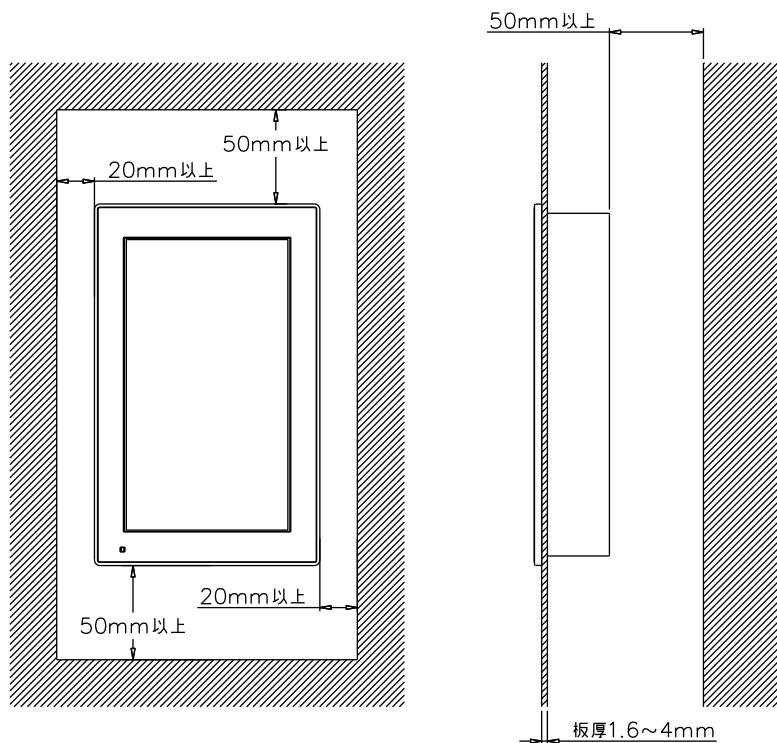
放熱の為、他の機器は本体より表記寸法以上離して設置してください。(上図参照)
