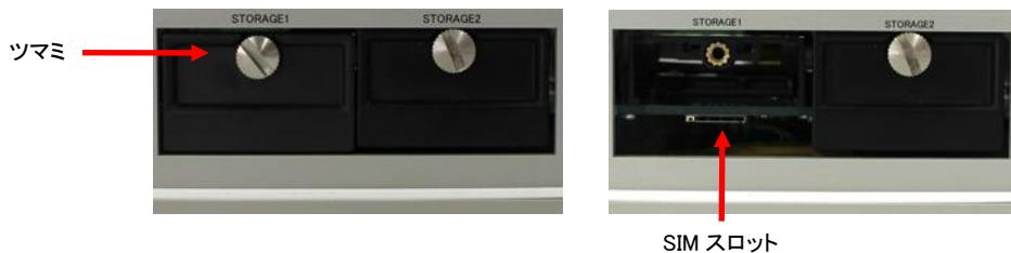
2. LTE 用 SIM カードの向きを確認し、SIM スロットに挿入します。カチッとき音が鳴るまで押込んでください
